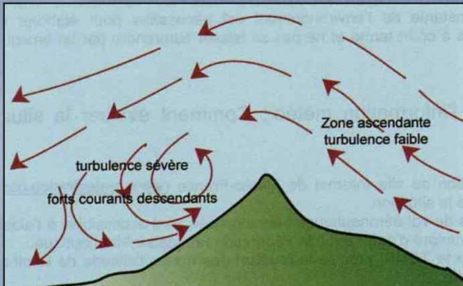
Déformation de l'écoulement atmosphérique avec de fortes ascendances ou subsidences
